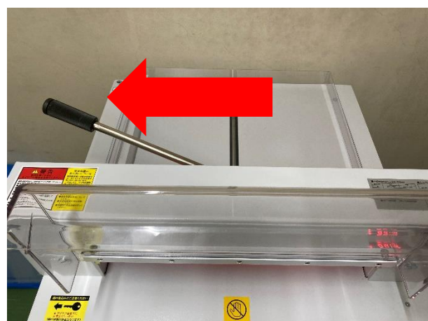
③ バーを倒して紙を固定する
