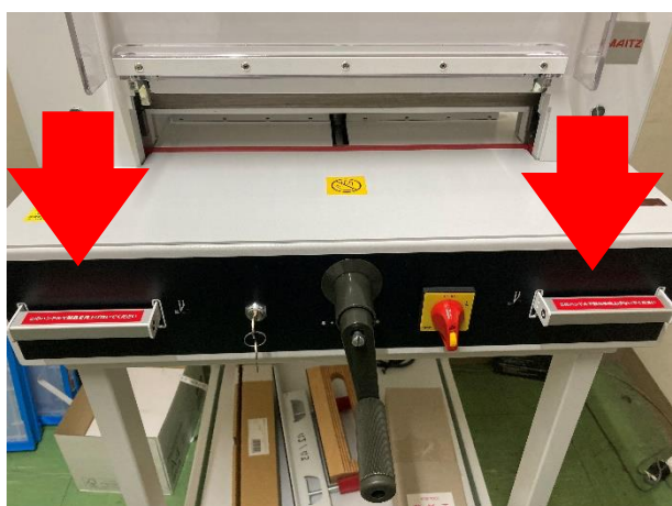
⑤ レバー2カ所を同時に押して裁断する
