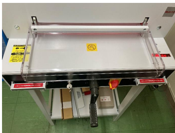
④ カバーを下して手を差し込めないようにする
